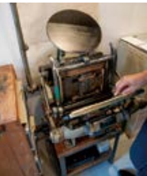
印刷機は、埼玉県の永井機械製作所のもの。上の丸い部分にインクを塗って手前に紙を置き、レバーを引いて1枚ずつ印刷する。
