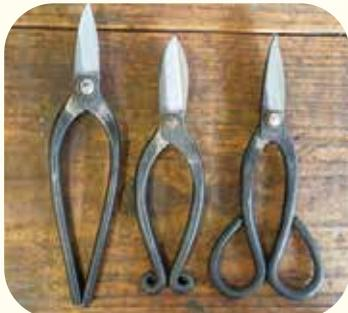
土佐打刃物は、使い手や用途に合わせて、多様な形状に造る「自由鍛造」の世界。笹岡鉄製作所でも、使用者の細かい要望に柔軟に対応しながら、鉗を製造している。
