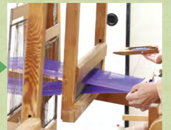
はた織り機で布に仕上げていく。着物を一着分織るのに約30万回シャトルを飛ばす。
