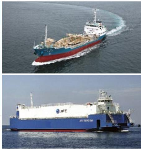
セメント専用船の立昌丸(右上)。鋼材専用船(Ro-Ro船)のJET TOKYO BAY(右下)は鋼材を積んだトラックごと積み込める仕様。
