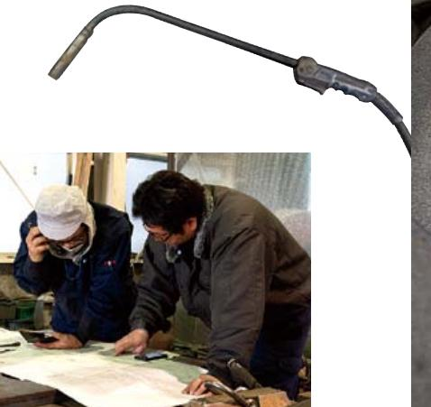
溶接をする前に、図面を見て、鉄の材料を組み立て、形づくる。そして曲がったり縮んだりすることを予測して仮止めする。「図面どおりにバシッと決まるうれしいねえ」。
